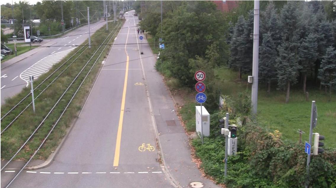
Abbildung 14: Anzeige des Videos des Kirchheimer Wegs im Messwerkzeug nach abgeschlossener Kalibrierung. Die eingezeichneten Linien zeigen die Lage der Fahrbahn­ränder und der Schutzstreifenmarkierung laut Kalibrierung.
