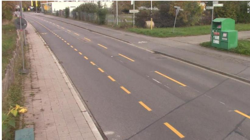
Abbildung 5: Markierungszustand III der Pleikartsförster Straße: 2 m Schutzstreifen plus 2,50 m Restfahrstreifen und 3 m Fahrstreifen für den Gegenverkehr
