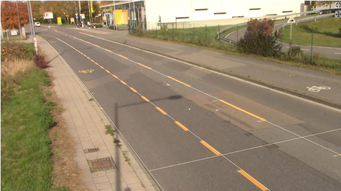
Abbildung 12: Anzeige des Videos der ersten Kamera der Pleikartsförster Straße nach abgeschlossener Kalibrierung. Die eingezeichneten Linien zeigen die Ränder der Bordrinnen und die Mitte der Markierung laut Kalibrierung. In Bezugsrichtung ist die innere Kante der Bordrinne eingezeichnet, da die äußere Kante durch den Bord verdeckt ist.
