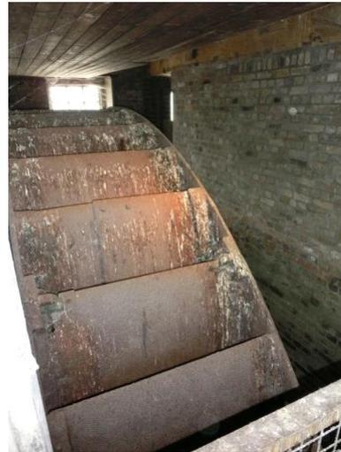
**Bild 16: Eines von vier Mühlrädern**
