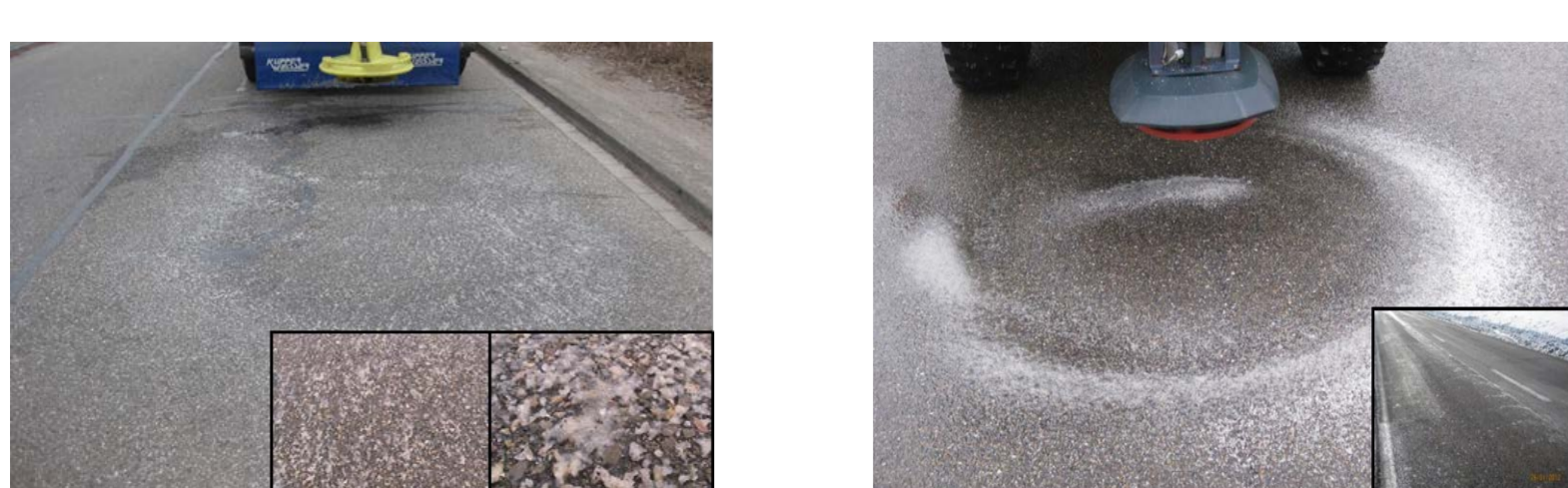
Streubild eines justierten (links) bzw. dejustierten Streuers (rechts)
