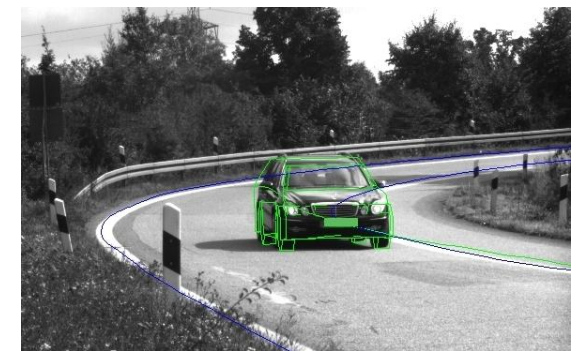
Fahrspurauswertung in Rampe (ISE)
