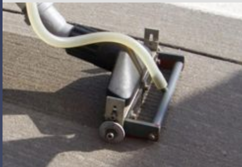
Saugmund mit Befeuchtungsdüsen
