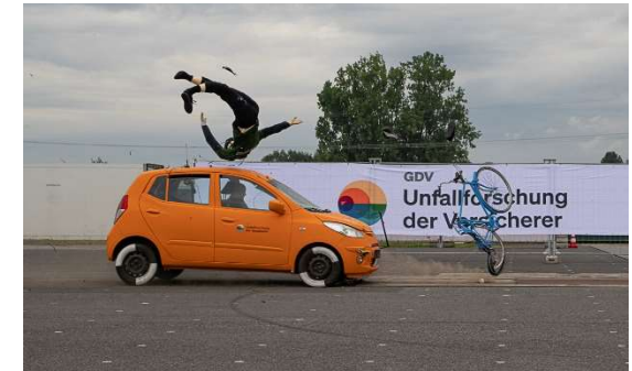
Crashtest zwischen Kfz und Fahrrad (Bild: Unfallforschung der Versicherer)
