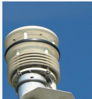
Abb.: Kompaktensensor WS 600; Fa. Lufft
