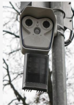
Abb.: Kamera Mobotix M16 mit IR-Scheinwerfer
