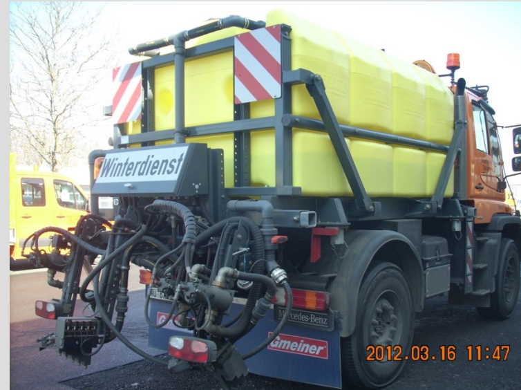
reine Solestreumaschine auf Unimog
