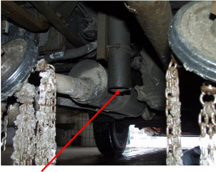
IR-Sensor innerhalb des Fahrzeugrahmens
