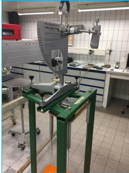
SRT-Pendelgerät in der Kühlkammer mit Bohrkern im Einspanntisch
