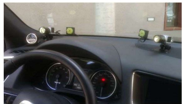
Innenraum des Untersuchungsfahrzeuges mit den beiden Kameras des Systems SmartEyePro und den dazugehörigen Infrarotreflektoren (KIT ISE, 2018)
