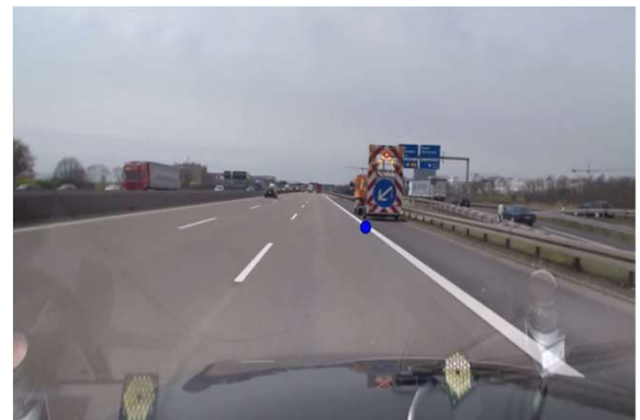
Vorbeifahrt an einer AKD als Ausschnitt aus der Ausgabedatei der Blickerfassungstechnik: Überlagerung von Aufnahme der Frontkamera mit dem Zielpunkt des Blickstrahls eines Probanden (KIT ISE, 2018)
