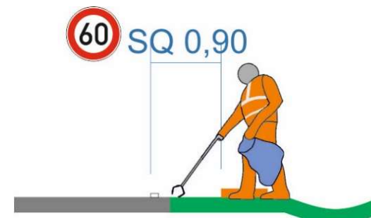
Beispiel für Arbeiten außerhalb der Straßenfläche (Bildquelle: Entwurf Handlungshilfe ASR)
