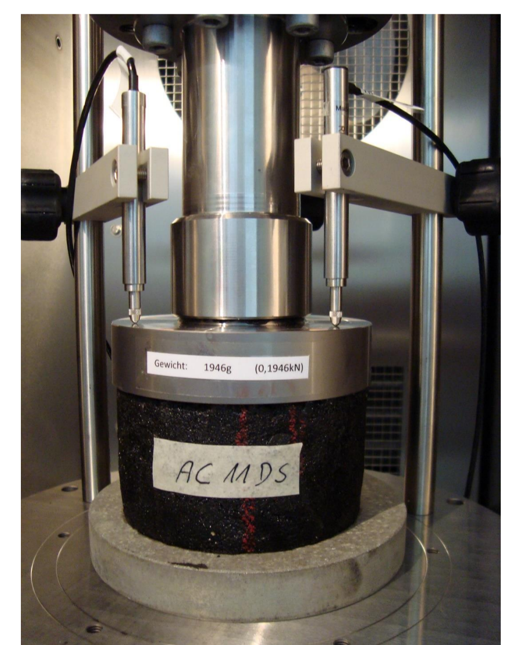
Prüfvorrichtung Druck-Schwellversuch (Verformungseigenschaften)
