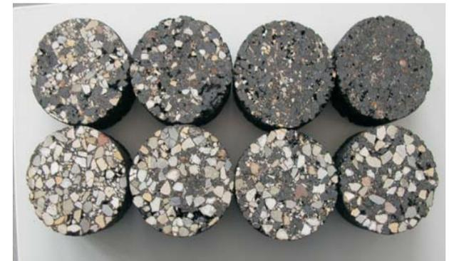
Verwendung von Elektroofenschlacke in Asphalt
