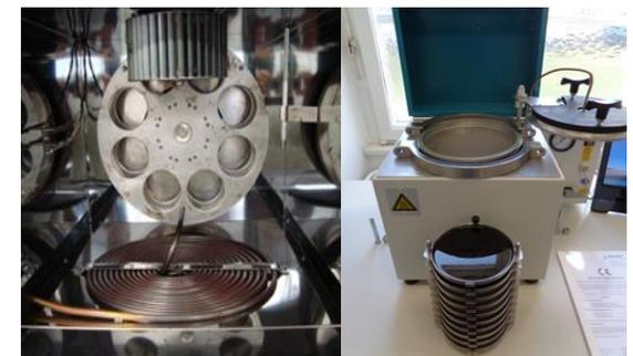
Simulation der Alterung von Bitumen
