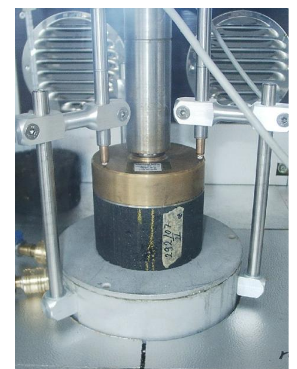
Prüfvorrichtung Druck-Schwellversuch (Verformungseigenschaften)
