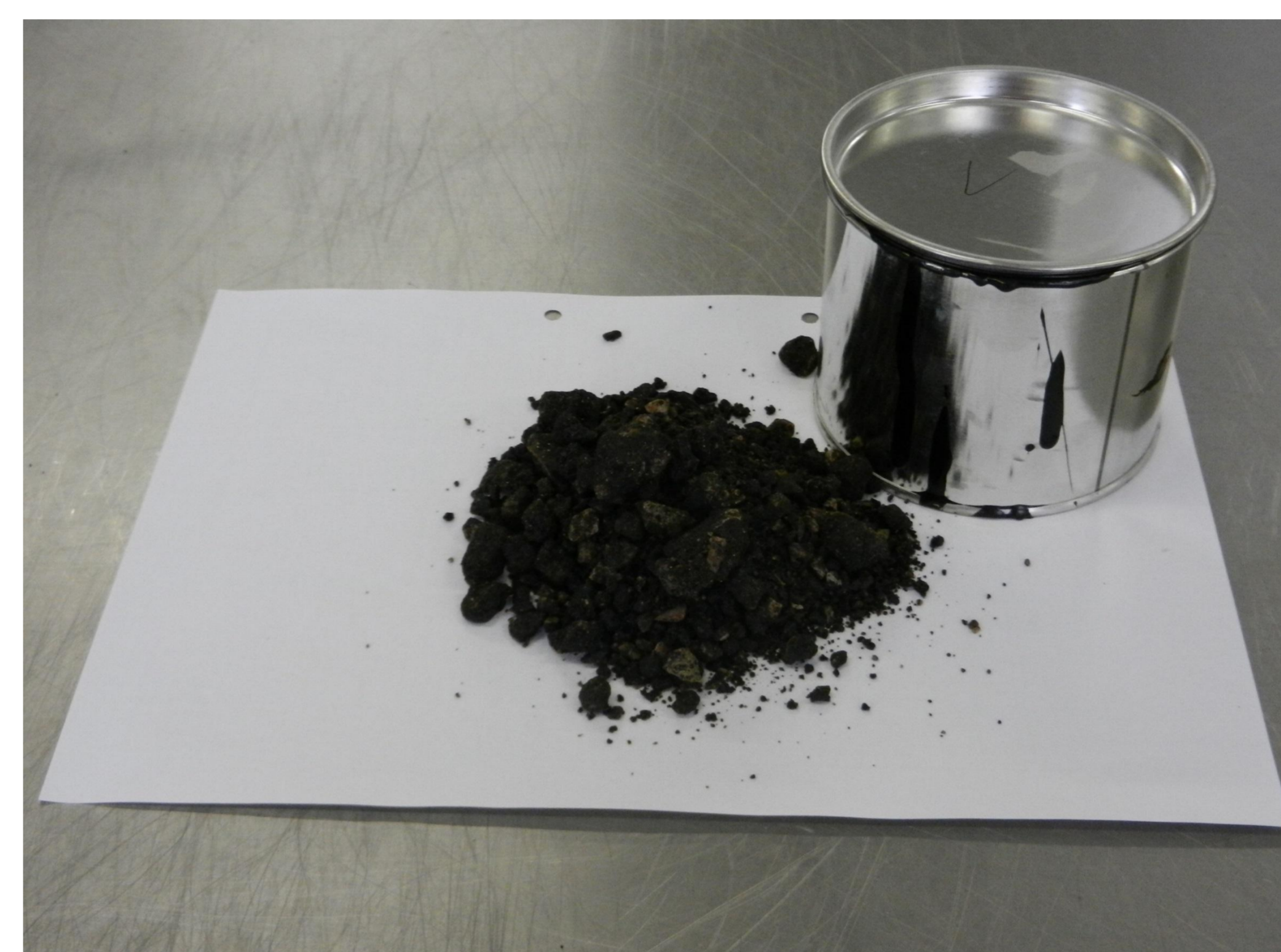
Reaktivierung des Asphaltgranulates durch „Reaktivio-Bit“-Zugabe
