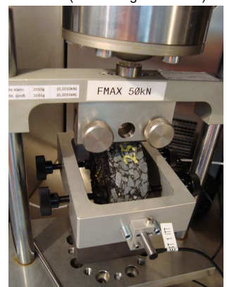
Prüfvorrichtung Spaltzug-Schwellversuch (Ermüdungs- und Steifigkeitseigenschaften)
