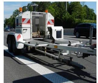
Falling Weight Deflectometer (FWD) (Tragfähigkeitsmessungen)
