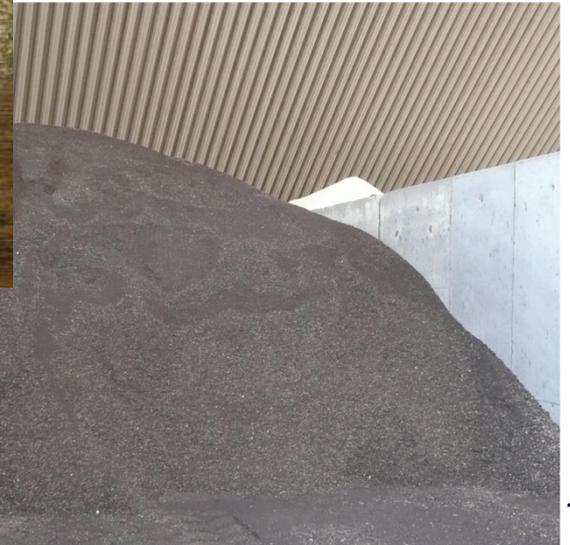
Splittmastixasphalt aus 85 % Asphaltgranulat
