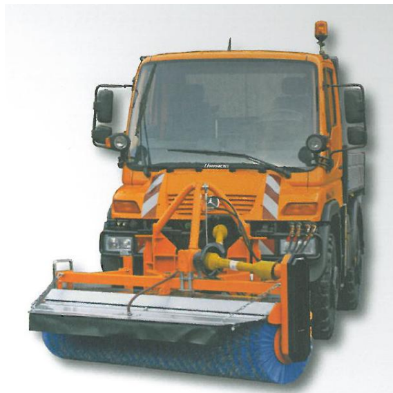
Bild 4.4: Anbau-Kehrmaschine (Werksfoto SCHMIDT)
