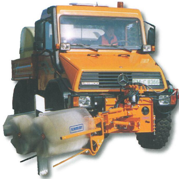
Bild 4.5: Leitpfostenwaschgerät (Werksfoto SCHMIDT)
