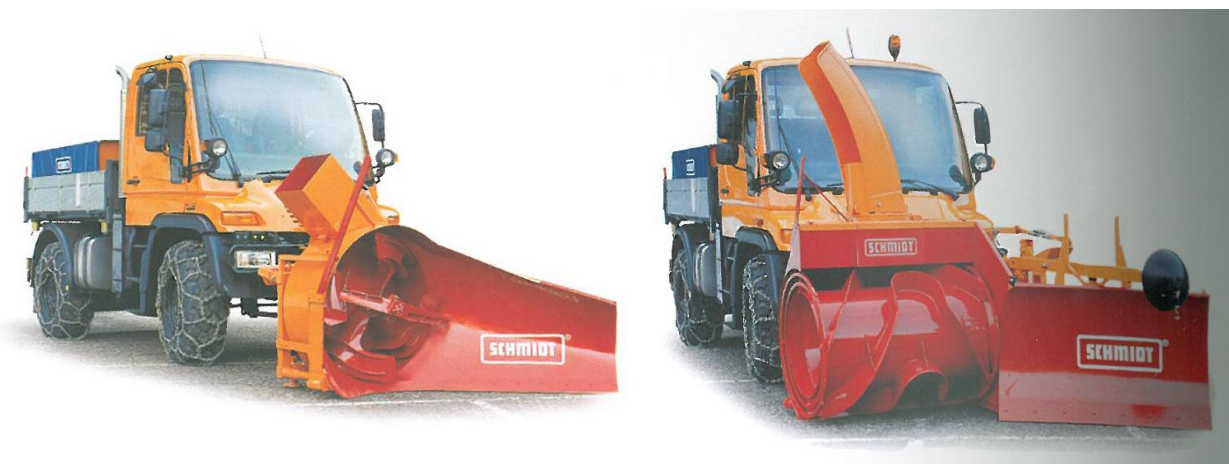
Bild 2.12: Anbau-Schneeschleuder und -Schneefräse (Werksfoto SCHMIDT)
