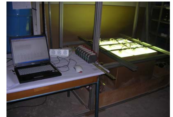
Bestrahlungsanlage zur thermischen Beanspruchung von Asphalt im Labor am ISE
